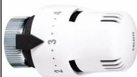
Sulla testa termostatica sono presenti dei numeri da 0 a 5. Posizionando la manopola in corrispondenza di una di queste cifre, si stabilisce il grado di apertura della valvola e, conseguentemente, la quantità d'acqua da far scorrere. In base a queste impostazioni è possibile regolare la temperatura ambiente come desiderato.
